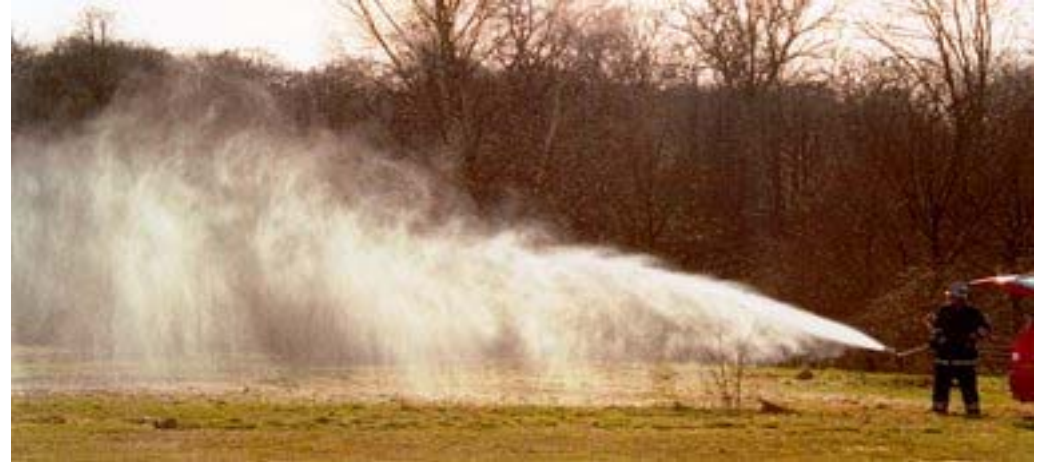
Довжина тонко розпиленого струменя від ствола FIREXPRESS сягає 15 метрів
