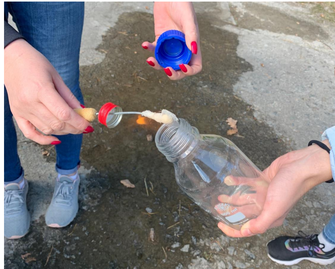
Процес відбору проб вод для аналізу параметрів епідемічної безпеки. Стерилізація контактної поверхні. Фото надано активістами смт Ворзель, 2022
